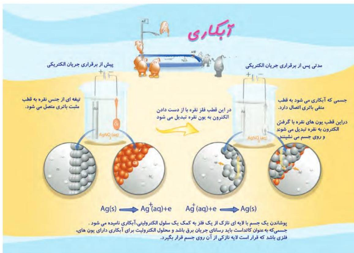
پوشاندن یک جسم با لایه ای نازک از یک فلز به کمک یک سلول الکتروولیتی، آبکاری نامیده می شود.
