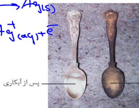
شکل زیر آبکاری یک قاشق فولادی را با فلز نقره نشان می‌دهد با توجه به آن:
