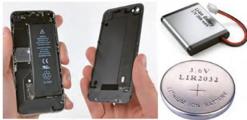
۱- لیتیم فلزی ارزشمند برای ذخیره انرژی الکتریکی است زیرا در میان فلزها کمترین چگالی و  $E^\circ$  و جرم مولی را دارا است. در نتیجه با استفاده از این فلز می توان باتری های سپکتر، کوچکتر و با توانایی ذخیره انرژی بیشتر تولید کرد.
