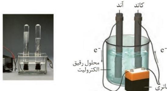
تجزیه آب به گازهای هیدروژن و اکسیژن با مصرف انرژی الکتریکی
