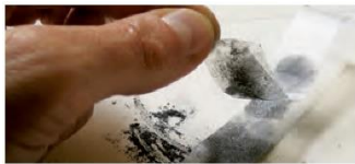
شکل ۴- تهیه گرافن با استفاده از نوار چسب
