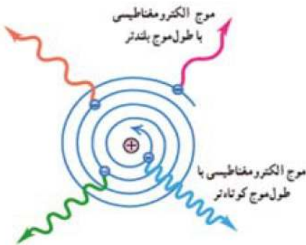
اگر الکترون دور هسته بچرخد، طیفی پیوسته گسیل می کند و سرانجام روی هسته فرو می افتد.
