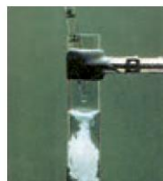
ب) افزودن محلول سدیم کلرید به محلول نقره نیترات باعث تشکیل سریع رسوب سفیدرنگ نقره کلرید می شود.
