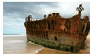
پ) اشیای آهنی در هوای مرطوب به کندی زنگ می زنند. زنگار تولید شده در این واکنش ترد و شکننده است و فرو می ریزد.
