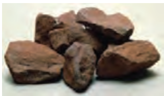
شکل ۸- سنگ معدن حاوی FeO و Fe_2O_3
